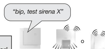
**ATTENZIONE:** se le sirene, i ripetitori radio o i ricevitori presentano una anomalia di alimentazione (pila al litio scarica), la segnalazione delle sirene, dei ripetitori radio o dei ricevitori è seguita da un segnale sonoro particolare che indica tale anomalia.
