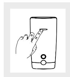
**ATTENZIONE: se la spia rossa non si accende premendo il pulsante test, è necessario sostituire la pila al litio**
