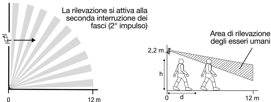
Per esempio, con una regolazione della sensibilità di livello 1, quando il rivelatore è fissato all'altezza di 2 metri, un essere umano alto 1,70 in piedi viene rilevato a partire da 4 m (d). Con l'aumentare del livello di sensibilità, si riduce la distanza "d" a partire dalla quale viene rilevata la presenza di un essere umano.
