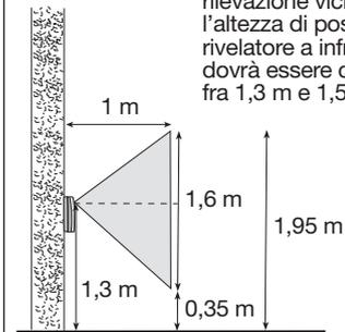
Per un'efficace rilevazione vicina, l'altezza di posa del rivelatore a infrarossi dovrà essere compresa fra 1,3 m e 1,5 m.
